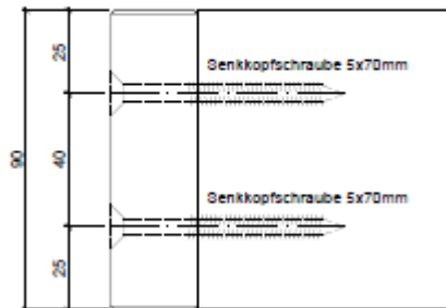
Rahmenverbindung (Ansicht von oben)
